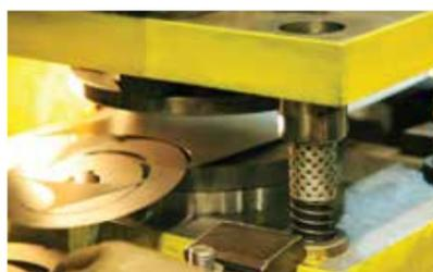
Mit einer installierten Fertigungskapazität von mehr als 7.500 Tonnen pro Jahr kann KCP eine Vielzahl von Laminierungen herstellen, die im Durchmesser von 50 bis 1.200 mm reichen. Die Fertigungsanlagen umfassen dabei fortschrittliche Stanzautomaten ebenso wie Einzelpunktnutung. Die erfahrenen und gut ausgebildeten und qualifizierten Arbeitskräfte tragen dabei ihren Beitrag dazu bei, eine phänomenale Präzision zu erreichen.
